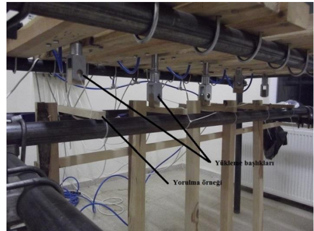
Şekil 6. Yorulma örnekleri ve yükleme düzeneği
