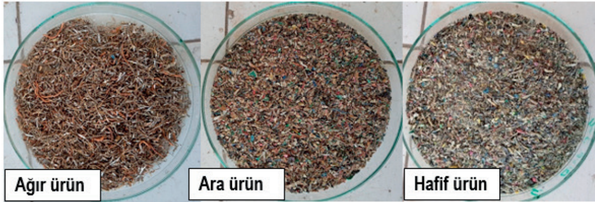
Foto 5. Zenginleştirme işlemleri sonucunda elde edilen ürünler (-2 mm metal ağırlıklı ürün)
