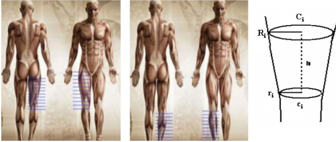
Şekil 1. Bacak Hacim ve Kütlesinin Hesaplanması (Frustum Metodu)
