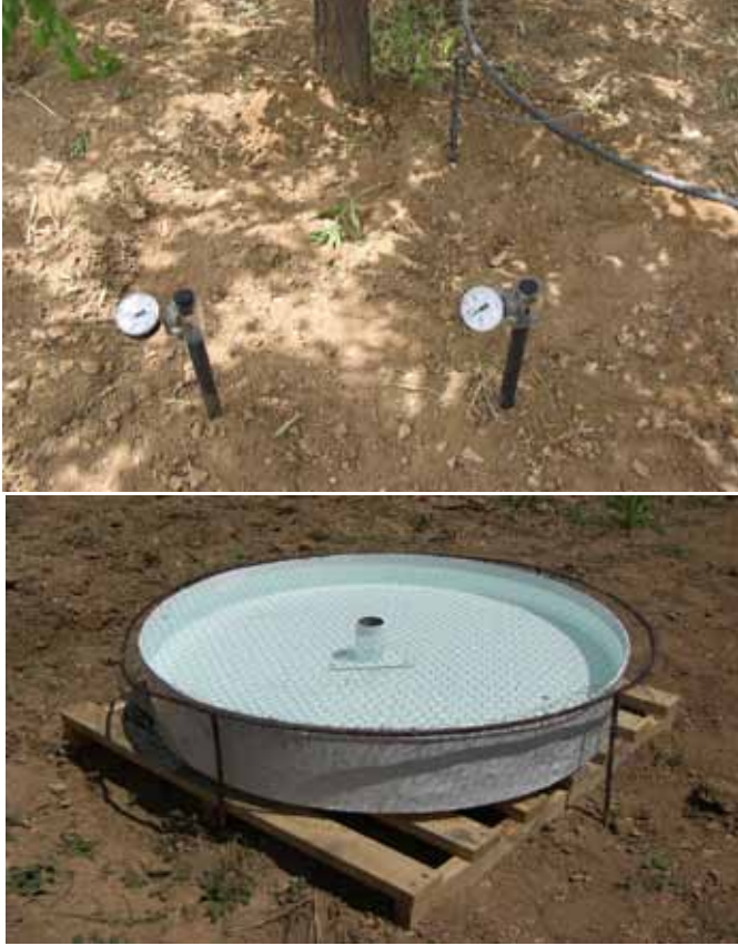
Şekil 1. Deneme alanına yerleştirilmiş tensiyometreler ve buharlaşma havuzu
