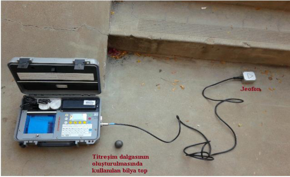
Şekil 2. Titreşim ölçüm cihazı ve titreşim kaynağı oluşturulmasında kullanılan demir bilya top. Figure 2. Vibration measurement equipment and the iron ball used to create vibration source.
