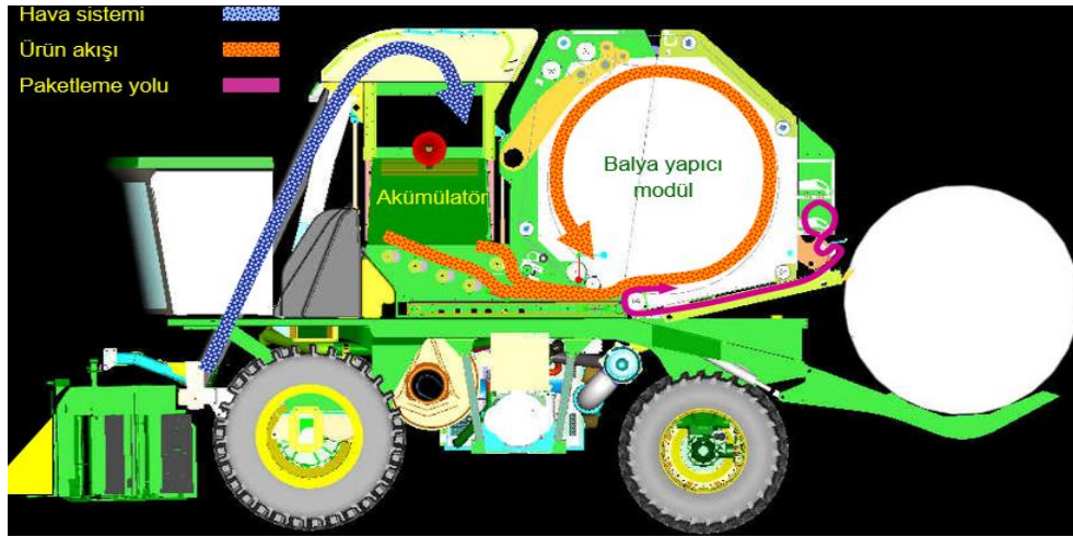
Şekil 11. Balyalı PHM ürün akışı
