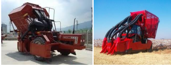
Şekil 1. Ülkemizde kullanılan testereleli tip toplama üniteli makineler
