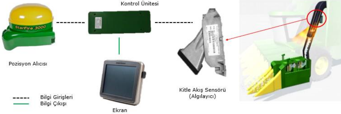
Şekil 9. PHM verim görüntüleme sistemi ve akış şeması
