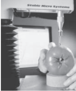
Şekil 2: Tekstür aleti farklı gıdaların tekstürünün ölçülmesinde kullanılır.
