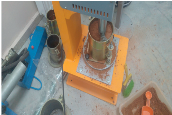
Foto 3. Otomatik modifiye proktor deney cihazı
