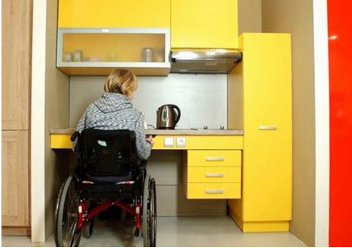
Görsel 14. Válek & Kačena tarafından engelliler için tasarlanan ayarlanabilen tezgahlı ve açığıya inebilen üst dolaplı modüler mutfak 18
