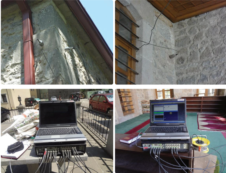
Şekil 22. Tavanlı Cami’deki ölçümde veri toplama sistemine ait görüntüler
