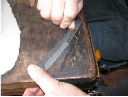
Fotoğraf No 13: Çevrilen mestin arka tarafına deri parçası dikimi
