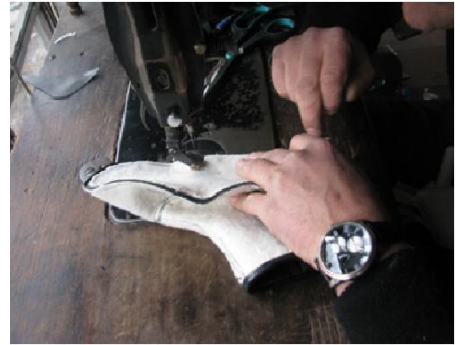
Fotoğraf No 15: Mestin taban kısmının yüz ile birleştirilmesi
