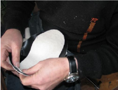
Fotoğraf No 15: Mestin taban kısmının yüz ile birleştirilmesi
