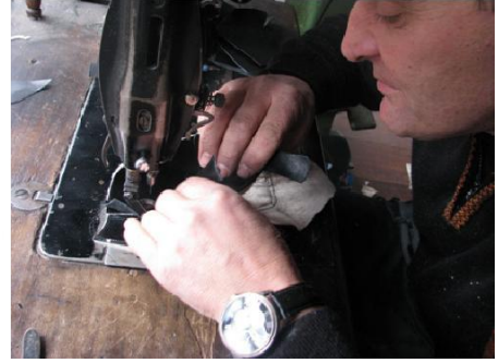
Fotoğraf No 13: Çevrilen mestin arka tarafına deri parçası dikimi
