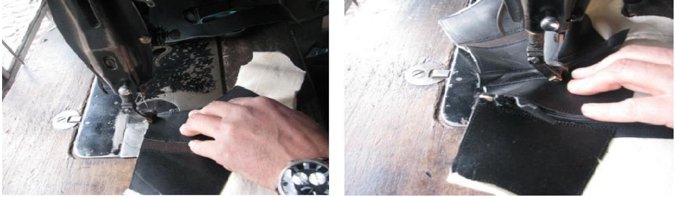
Fotoğraf No 9: Yan parçaların önden birleşimi ve birleşen parçaların üstüne deri ile makinede süs yapımı
