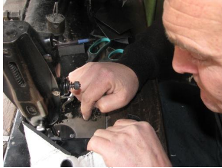
Fotoğraf No 14: Mestin boğaz kısmına deri parçası dikimi
