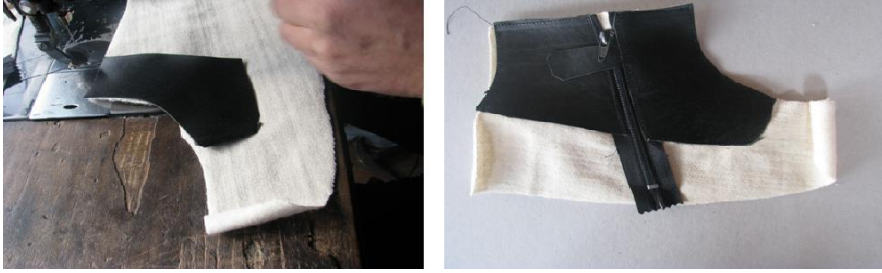
Fotoğraf No 8: Mest yan parçalarına miflon dikimi
