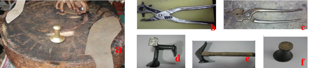
Fotoğraf No:4 Mest yapımında kullanılan araçlar (a: tezgâh, b: Çarklı zimba, c: tanalıya, d: örs, e: çekiç, f: muşta)
