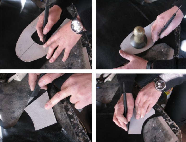
Fotoğraf No 7: Mest parçalarının endaze ile kesimi
