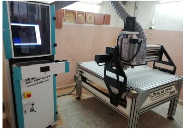
Şekil 1. Skilled CNC 2040 üç eksen CNC dik işleme tezgahı (Aras, 2019)
