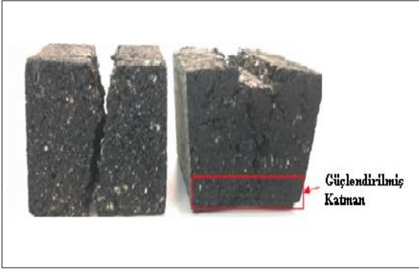
Şekil 4. Geocell ile güçlendirilmiş asfalt (Lee vd., 2021)
