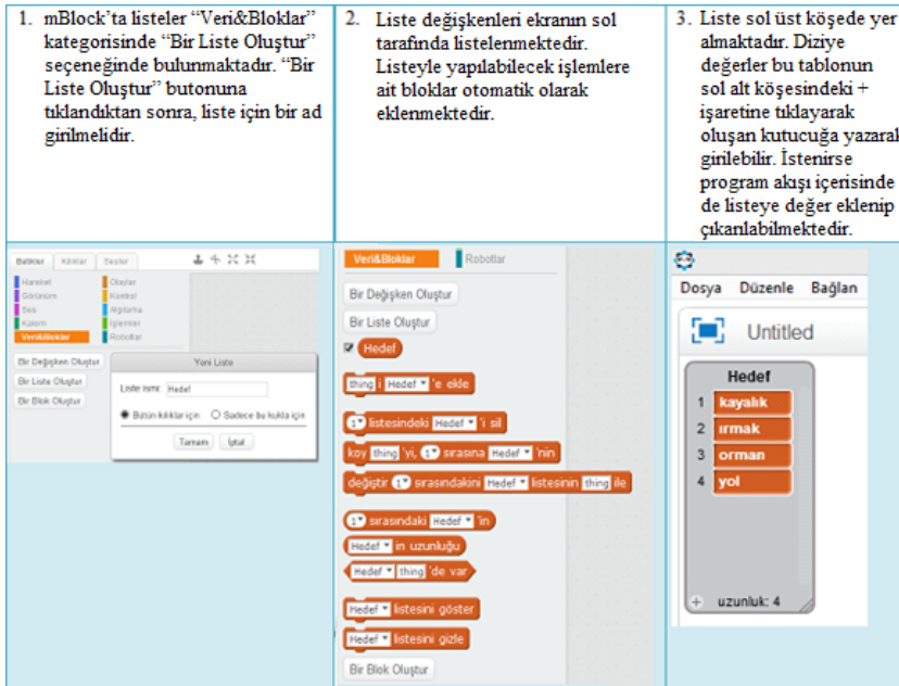
Şekil 7. mBlock programlama dilinde "liste" oluşturulması ve kullanılan "liste" blokları
