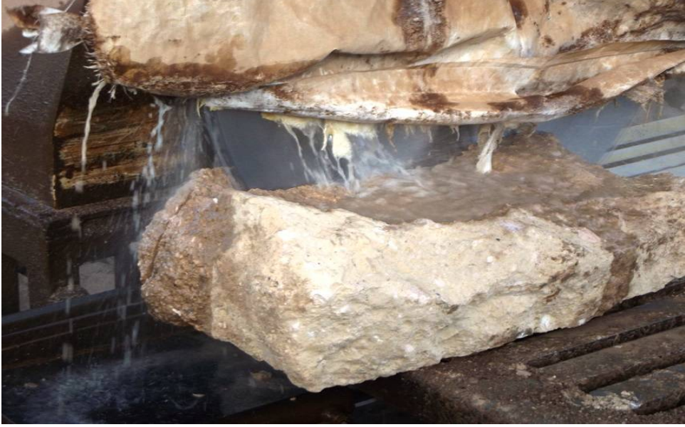
Resim 3. Hızarda Taş Bloğunun Kesilmesi
