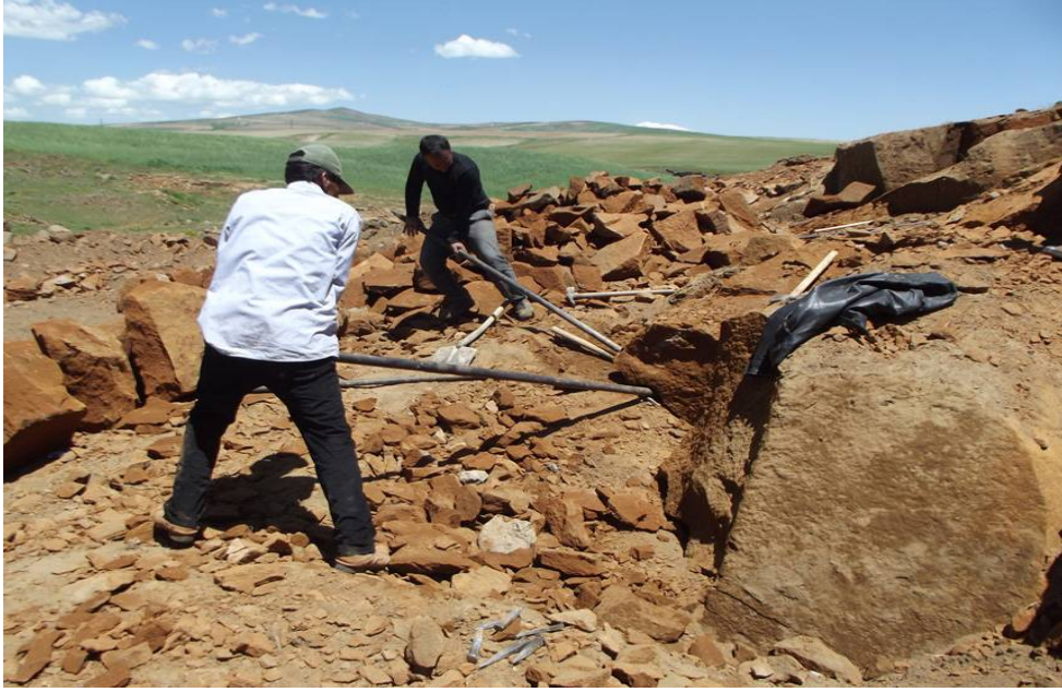
Resim 1. Kuskü ile Taş Bloğunun Yerinden Oynatılması
