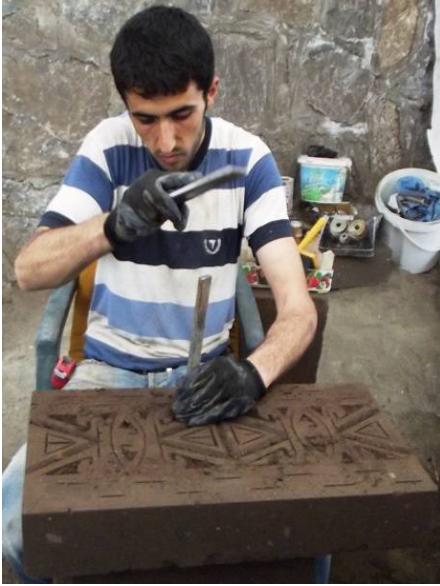
Resim 9. Oyma Yöntemiyle Taşa Desen Verilmesi
