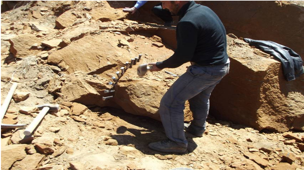
Resim 2. Çivilerle Taş Bloğunun Çatlatılması
