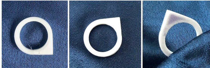
Şekil 29: Soldan sağa; baskı sonrası, yıkama sonrası, kuvvet uyguladıktan sonra.
