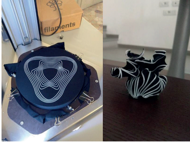
Şekil 13: Gergin kumaş üzerine alınan 3B baskı ve kumaşın tabladan söküldükten sonra aldığı form.
