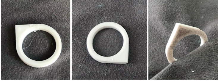
Şekil 30: Soldan sağa; baskı sonrası, yıkama sonrası, kuvvet uyguladıktan sonra.
