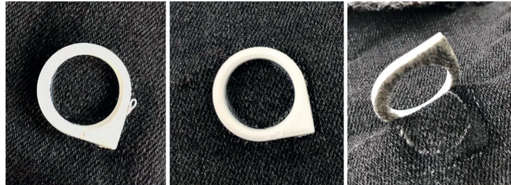
Şekil 24: Soldan sağa; baskı sonrası, yıkama sonrası, kuvvet uygulandıktan sonra.
