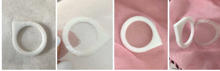
Şekil 19: Soldan sağa; baskı sonrası ön ve arka yüz, yıkama sonrası, ters yönde kuvvet uygulandıktan sonra.
