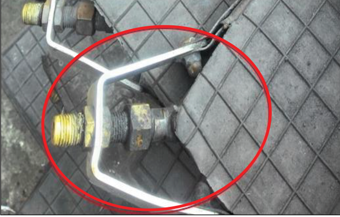
Şekil 14. TTK'ya son alınan hava yastıklarının nipel bağlantısı
