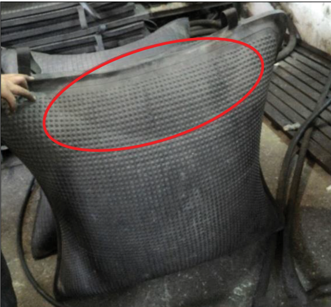
Şekil 15. Hava yastıklarında meydana gelen balonlaşma arızası
