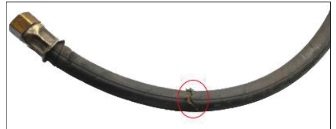
Şekil 10. Sava marka hava yastığına ait hortumda meydana gelen yarılma
