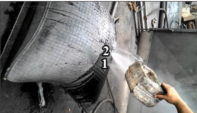
Şekil 12. Şişirilmiş hava yastığının su ile kontrolü
