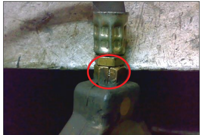
Şekil 13. Hava yastığının nipel kısmının çatlaması
