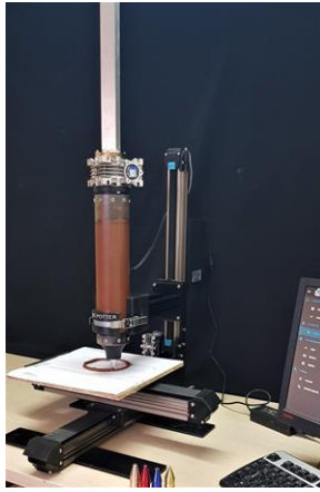
Şekil 7. 3B Potterbot Seramik Yazıcısı (Fotoğraf: S.Ünal)
