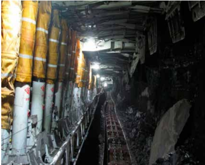
Şekil 2. Tam mekanize bir uzunayaktan görünüm (Yetkin, 2013)
