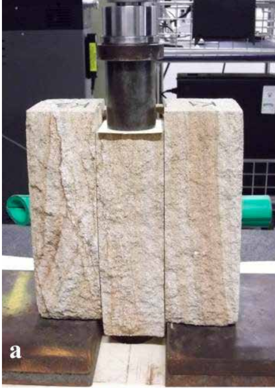
Şekil 13. Çapsal Daralma Testi
