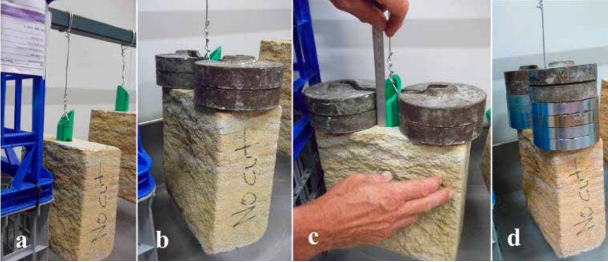
Şekil 14. a) Askıdaki Polimer Saplmalı Bloklar, b ve c) Blok Üzerine Konan 15 Kilogram Yük, d) Blok Üzerindeki 39 Kilogram Ağırlık
