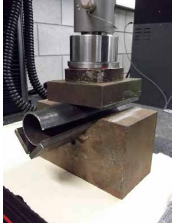
Şekil 13. Çapsal Daralma Testi
