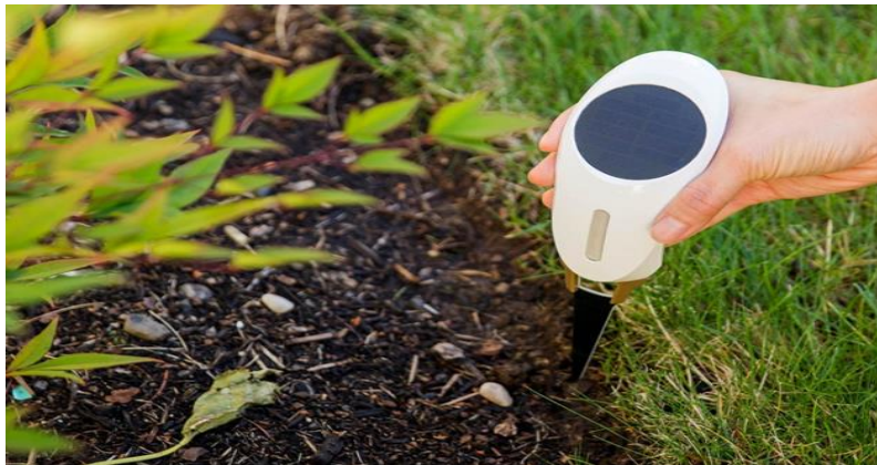
Şekil 4. Toprağın nemini ölçen ve yetersiz olduğu durumlarda uyarı veren bir bitki sensörü
