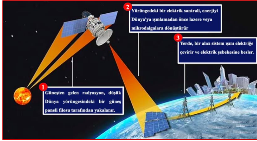
Şekil 2. Uzay Tabanlı GES Çalışma Prensibi [4].
