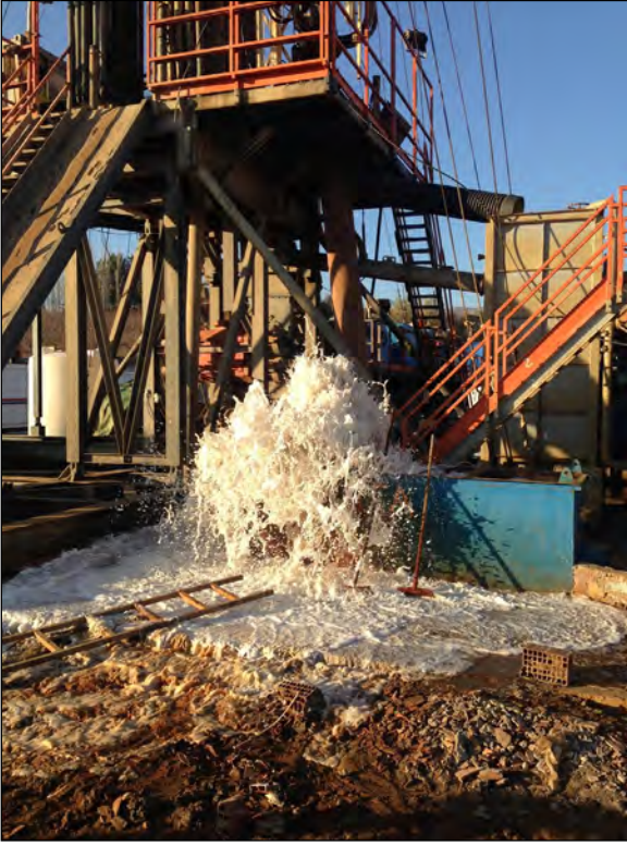
Şekil 13- AMÇ-2016/3 jeotermal sondajı asitleme sonrası üretim çalışmaları.
