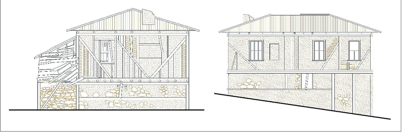
Şekil 16. Laçın geleneksel konutunun strüktür elemanlarının cephe rölövesi üzerinden çizimi 2 / Drawing the structural elements of the Laçın traditional house through the facade survey 2 (Çizim. Öztürk, 2023).
