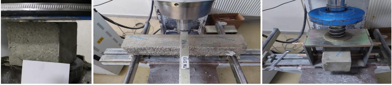
Şekil 7. Basınç dayanımı, eğilme dayanımı ve yarmada çekme dayanımı testlerine ait görseller
