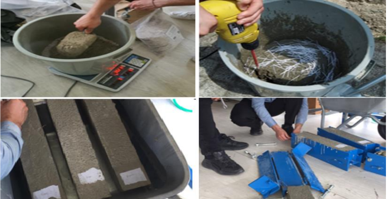
Şekil 5. Beton karışımının hazırlanması, liflerin ilave edilmesi, betonun kalıplara yerleştirilmesi ve kalıptan sökülmesi
