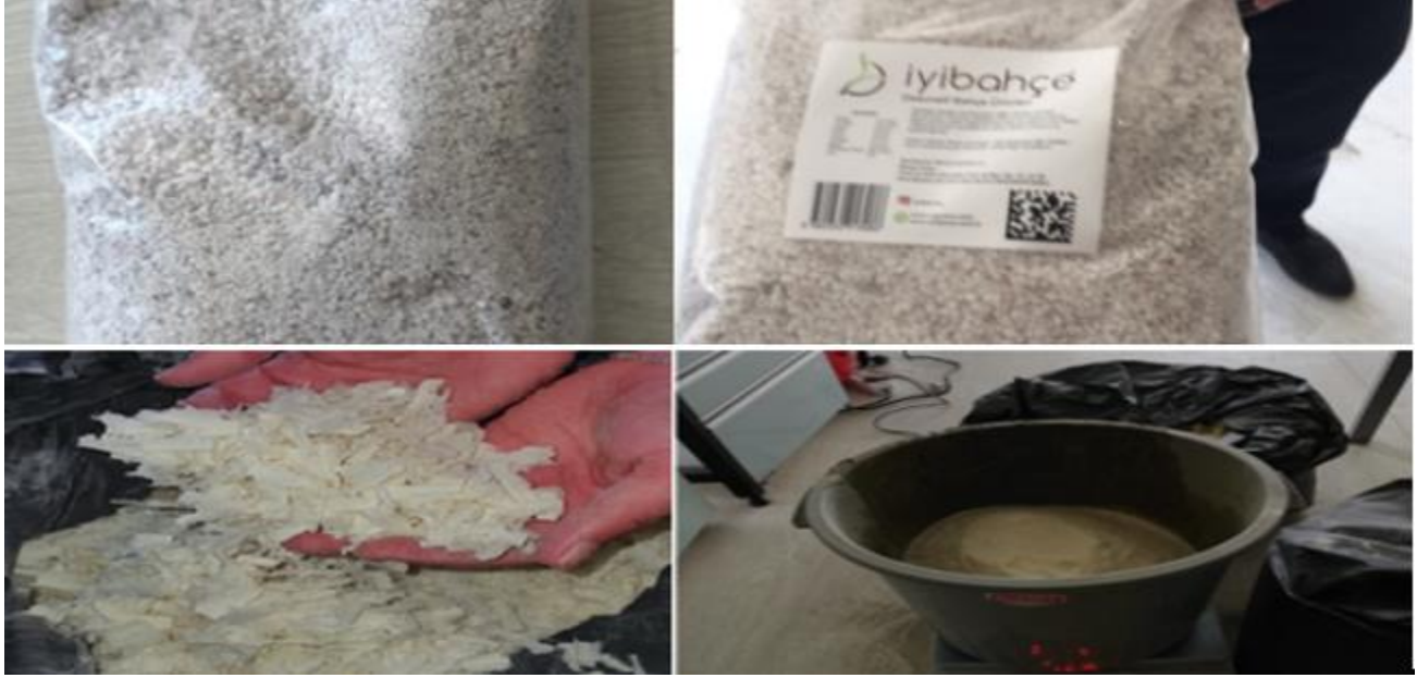
Şekil 2. Perlit ve poliüretan atık agreganın görüntüsü
