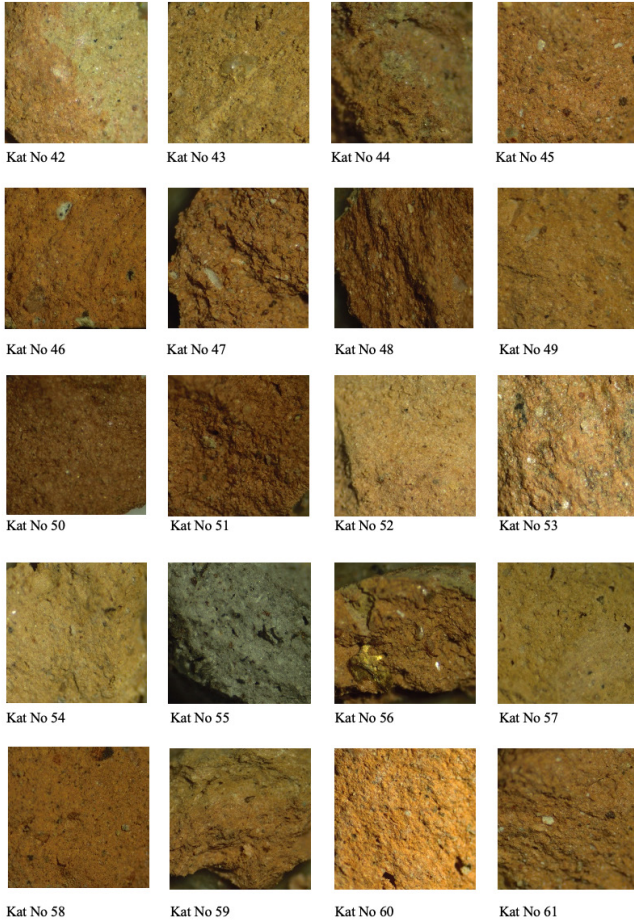
Fig. 10. Olympus SZ 61 Optik Mikroskop ve kamerası ile çekilen kil fotoğrafları
