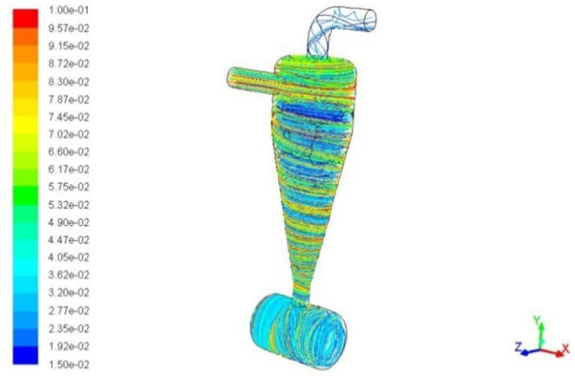
Şekil 7. RSM türbülans modeli için 2" (S20) hidrosiklon filtrede 2.93 \text{ ms}^{-1} hız değerinde ayırık faz modeli için değişik çaplardaki partiküllerin meydana getirdiği yörüngeler ve ayırma durumu
