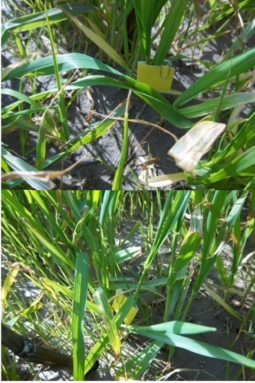
Şekil 3. Suya duyarlı kağıtların buğday bitkisi üzerine yerleştirilmesi
