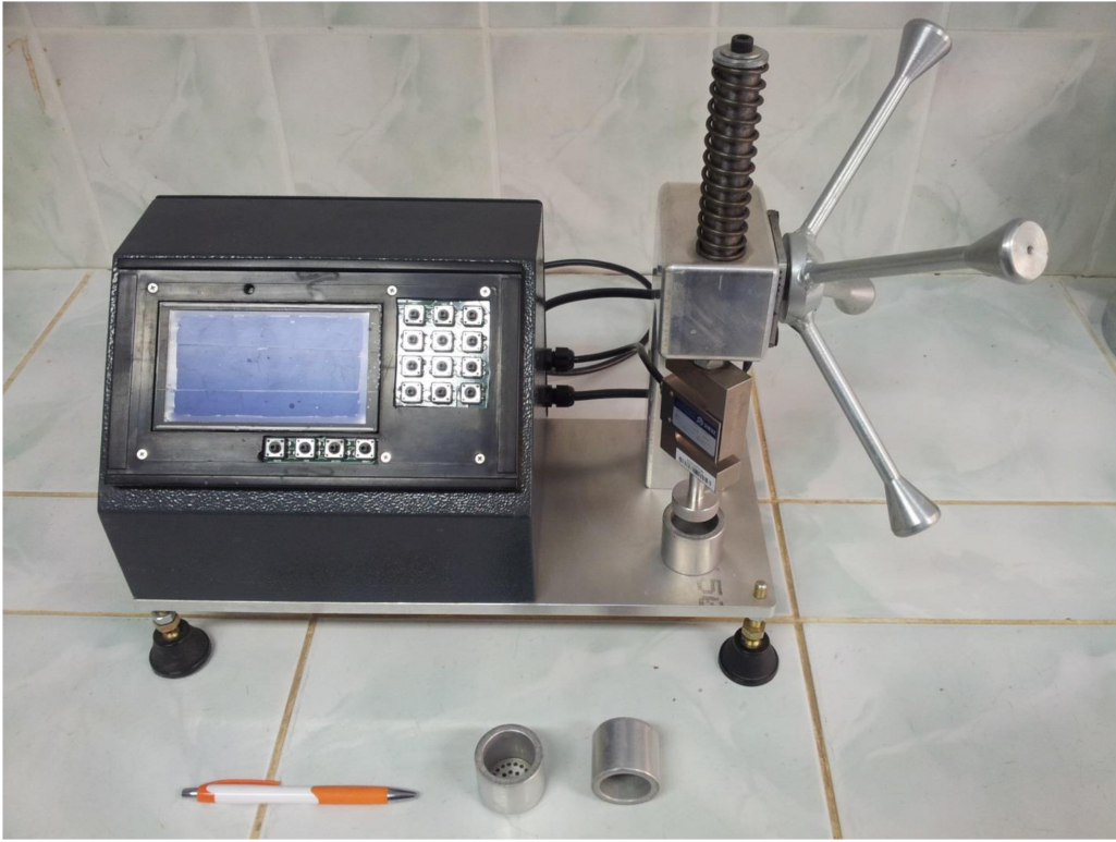
Figure 2. A view of the mud press machine and its components. Şekil 2. Çamur sıkma makinası ve bileşenlerinden bir görünüm.
