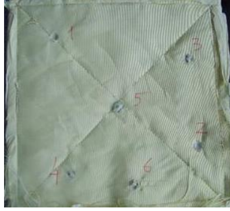
Şekil 3. Aramid Twaron Ct710 kumaşı üzerine yapılan balistik deney (Karahana, 2008)
