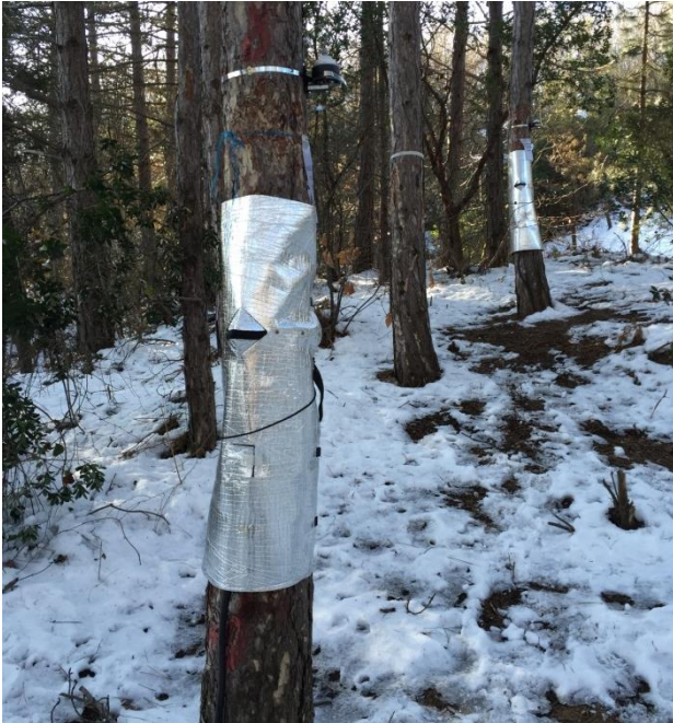
Şekil 4. Sensörlerin dış şartlardan etkilenmesini ve içeriden ısı kaybını engelleyen poliüretan köpük ile örnek ağacın izolasyonu (Foto: M.S. Özçelik)
