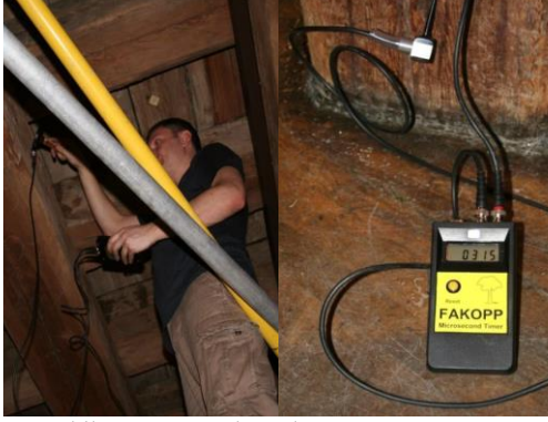
Şekil 1. Stres Dalga ölçümü (URL2,2016).
