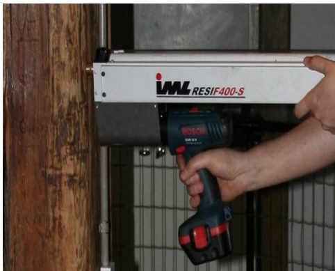
Şekil 2. Resistograf cihazı ve delme ucu (Tampone, 2001).
