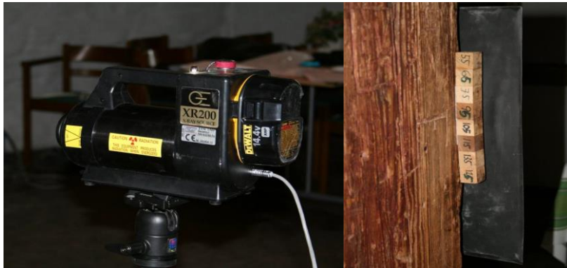
Şekil 4. X-Ray yönteminde kullanılan cihaz ve kalibrasyonu (URL2,2016).
