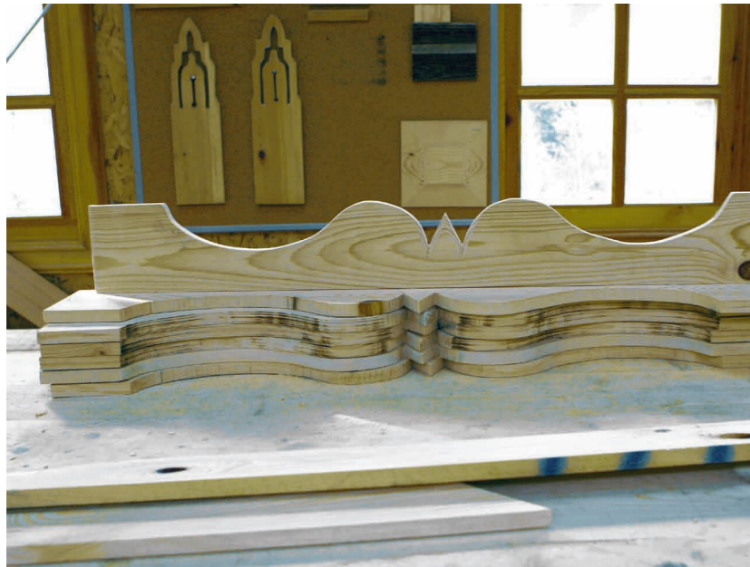
Ahşap elemanların yeniden üretilmesi (sol), çürüyen kısımların yerine parça eklenmesi (sağ)
