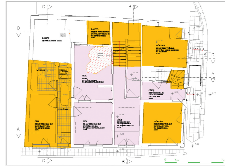
Zemin Kat Planı "HASAR TESPİTİ"
