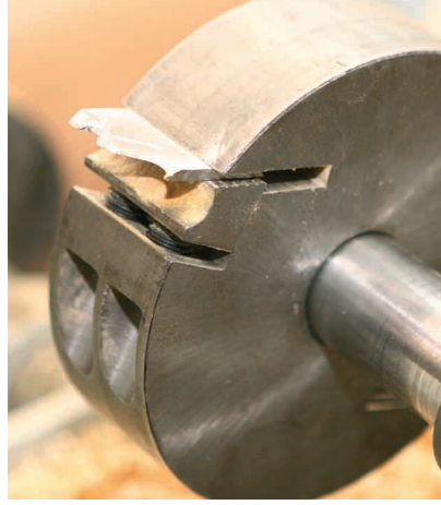
Profile uygun hazırlanan bıçak ve profil
