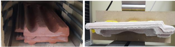
Şekil 3. Kiremitlerin ısıtılması ve donmuş kiremitlerin eğilme testi ( -50\text{ }^{\circ}\text{C} ) (Heating of roof tiles and flexural test of frozen roof tile)
