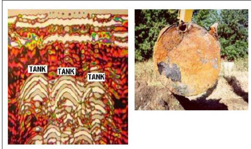
Şekil 27. Üç adet yer altı depolama tankının (YDT), 400 MHz anten ile GPR görüntüsü (solda) ve YDT'nin yeryüzüne çıkarılmış görüntüsü (sağda) (URL-7).
