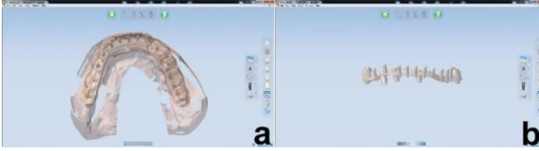
Resim 3. (a) Geçici alt tam protezin model tarayıcı ile taratılıp programa aktarılması, (b) Bilgisayar yazılımı ile dizayn edilen vidalı titanyum altyapı tasarımı.
