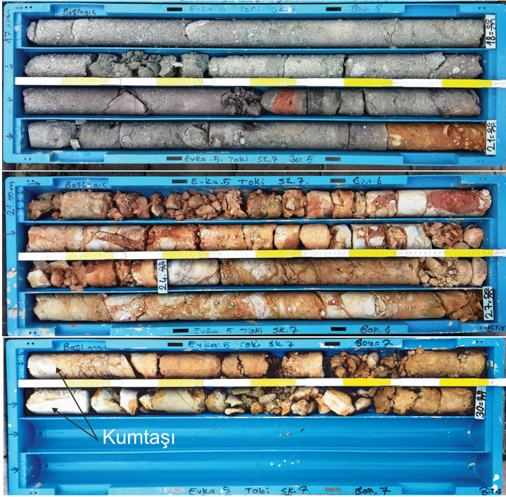
Şekil 13. SK-7 sondaj kuyusunda, 21 m derinliğinde aglomera-filiş dokanağında gelişmiş oksitlenme-pişme nedeniyle meydana gelen pembe renkli breşik zon (F 3 fay zonu, 20.8 - 21.0 m arası fay kili ve 21.1 - 21.55 m arası da fay breşi olarak değerlendirilmiştir). Figure 13. In BH-7 borehole, down to 21 m from the ground surface, breccia zone with pink colour occurred due to oxidation and baking in the contact between agglomerate and flysch units.
