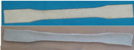
Şekil 3. Standart ve büzüşmüş test numuneleri
