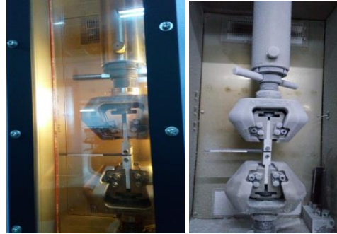
Şekil 5. Farklı ortam sıcaklıklarında yapılan mod I kırılma testleri
