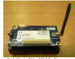
Şekil 6. Bir IRIS düğümü (An IRIS node)
