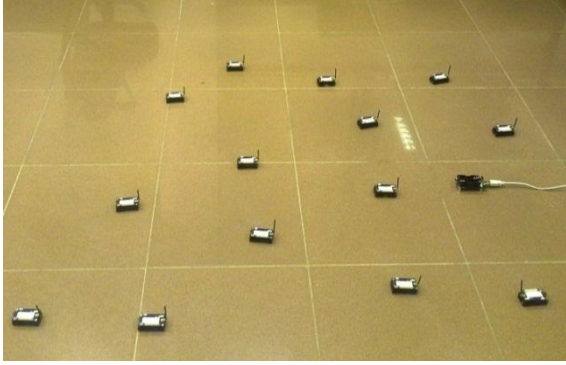
Şekil 10. IRIS düğümleri ve çıkış düğümü (IRIS nodes and a sink node)
