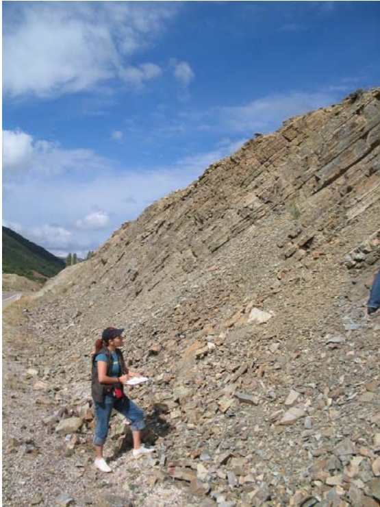
Şekil 3. Kaya kütlelerindeki hakim kırıklı yapı. Figure 3. Jointed structure of rock masses.
