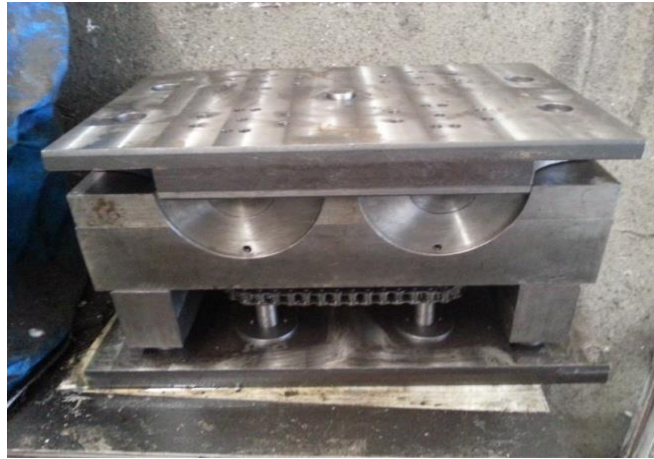
Şekil 13. Çift lokmal kalıp üretimi
