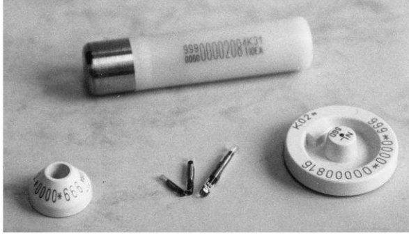
Şekil 2. Elektronik kulak numaraları, enjekte edilebilir transponderler ve retikuluma bırakılan boluslar
