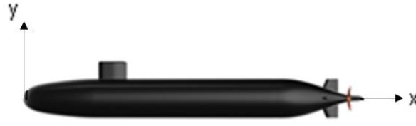
Şekil 2. Pervaneli Darpa Suboff konfigürasyonu ve kullanılan koordinat eksenleri
