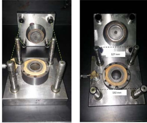
Şekil 5.14. Çelik kalıptaki demir sütunların asimetrik ölçülerde konumlandırılması
