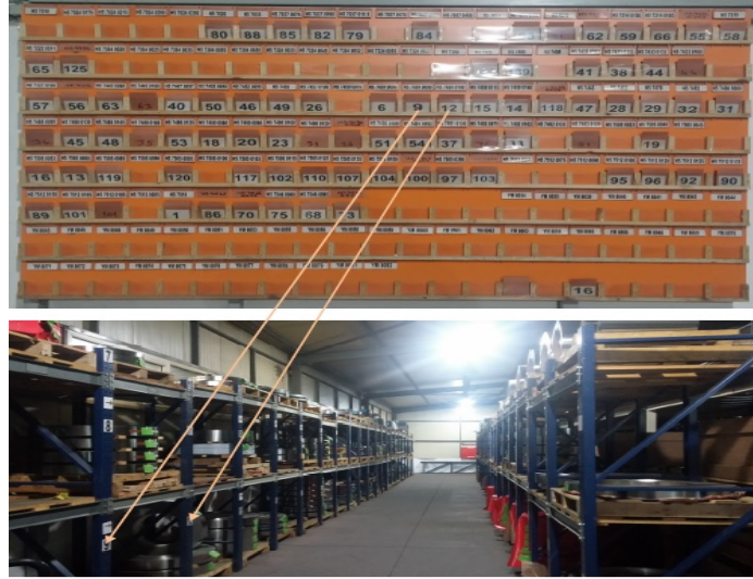
Şekil 5.7. Malzemelerin belli bir nizamaya uygun şekilde yerleştirilmesi
