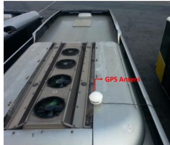
a: GPS Anteninin Metrobüs Üzerine Montajı
