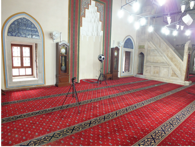
Fot 10: Ölçüm düzeneği - Alıcı ve kaynak noktası yerleşimi
