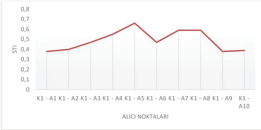
Şekil 7 - Hacim genelinde STI değerinin alıcı noktalarına göre değerleri
