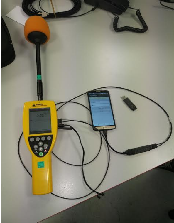
Şekil 12. Ölçüm cihazının telefon bağlantısı (Connecting the measurement device to the phone)
