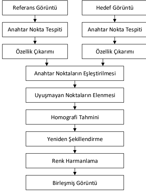
Şekil 3. Özellik tabanlı görüntü mozaikleme adımları [20] (Steps of feature-based image mosaicing)
