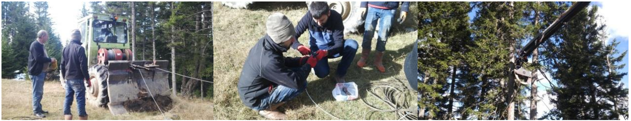
Şekil 4. AcarMHH300 sistemi için traktörün sabitlemesi ve kurulumu
