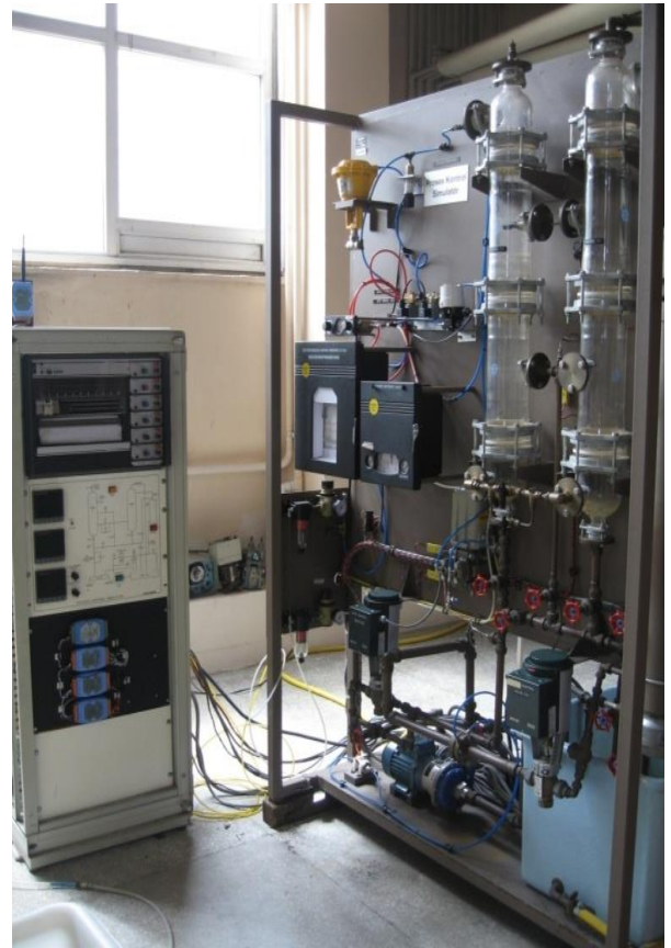
Şekil 1. Kablosuz ölçüm ve kontrol için geliştirilen proses kontrol simülörü (Developed process control simulator for wireless measurement and control)
