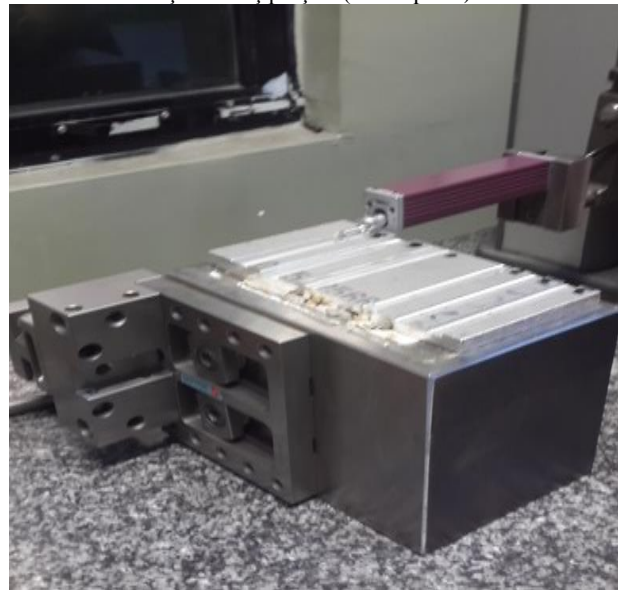
Şekil 7. Yüzey pürüzlülüğü ölçümü (Surface roughness measurement)
