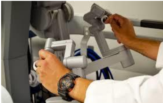
Şekil 2. Robotun kontrolü için kullanılan bir master sistemi (A master system for the control of surgical robot)
