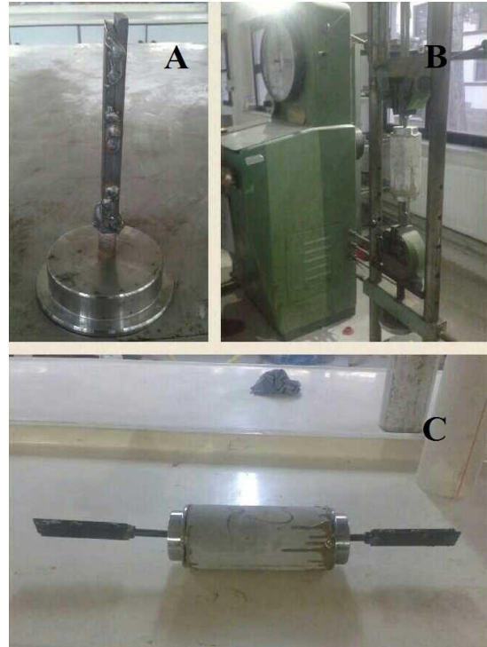
Şekil 3. Çekme dayanımı deneyinde kullanılan a) beton numunelerin yüzeylerine yapıştırılan çelik başlık, b) doğrudan çekme deney makinası c) çelik başlık yapıştırılarak doğrudan çekme deneyine hazır hale getirilmiş bir beton numunesi (Used in the experiment of tensile strength a) a steel helmet adhered to the surfaces of concrete samples, b) a direct tensile test machine, c) a concrete sample made available for direct tensile testing by adhering steel helmet).
