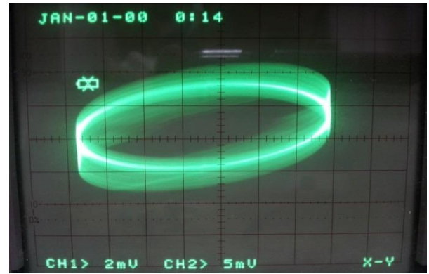
Figure 7. A chaotic attractor from the R2L2D circuit. The input parameters are V_{pp} = 8.16 V and f = 153.3 kHz. (R2L2D devresinden elde edilen kaotik bir çekici. Giriş parametreleri V_{pp} = 8.16 V ve f = 153.3 kHz.)
