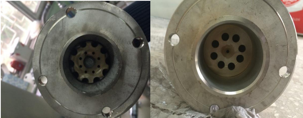
Şekil 3a. Ön-karışimsız (sol) ve ön-karışimli (sağ) metan brülörleri (Non-premixed (left) and premixed (right) methane burners)
