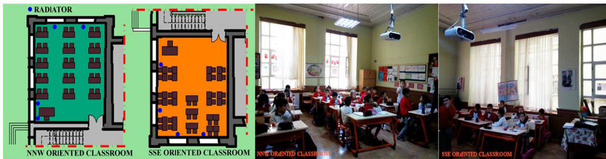
Figure 3. NNW and SSE Oriented classrooms on ground floor plan in the historic building (Tarihi yapıda KKB ve GGD yönüne bakan sınıflar ve Zemin kat planı)
