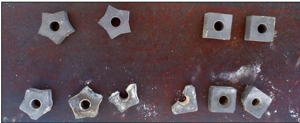
Şekil 4. Zincirli kollu kesici soketlerinin kırılma şekilleri, eski ve yeni soketlerin görünümü. (Breaking patterns of the chain saw machine's sockets and some view of new and used sockets).
