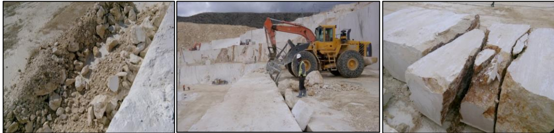
Şekil 11. Hazırlanan kesimin yıkım işleminden önce altına hafriyat ile beslenmesi, yıkılma ve yıkıldıktan sonraki görünümü. (View of the before and after turnover of the block)
