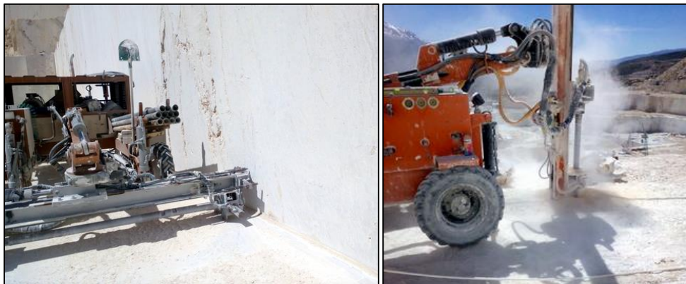
Şekil 10. Yatay delik delme ve düşey delik delme işlemleri (Horizontal and vertical drilling operations)
