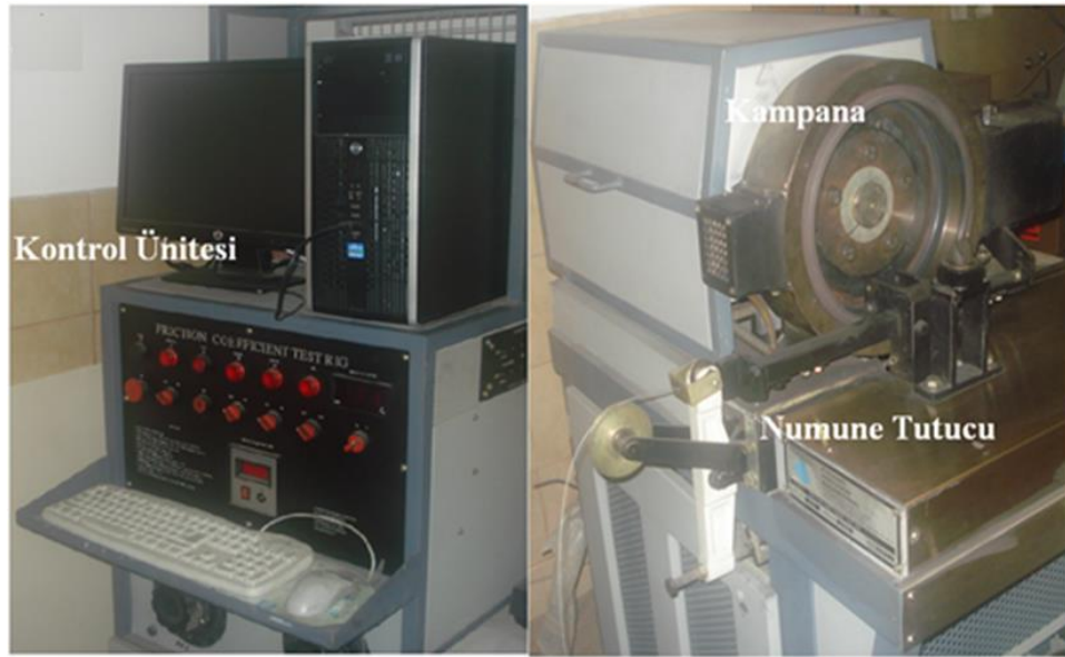
Şekil 3. Chase tipi sürtünme aşınma test cihazı (Chase-type friction-wear test machine employed in the testing)
