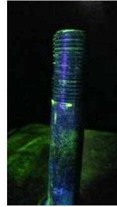
Şekil 7. Cıvata üzerinde manyetik parçacık kontrol yöntemi ile tespit edilmiş bir çatlak [11]
