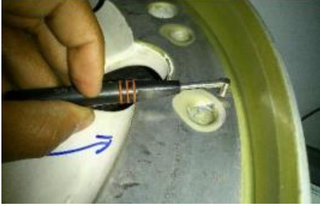
Şekil 9. Cıvata delik çevresinin girdap akımları kontrol yöntemi ile kontrol edilmesi [11]
