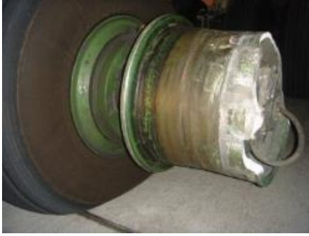
Şekil 5. Kalkış sırasında kırılan bir uçak jantı [8]
