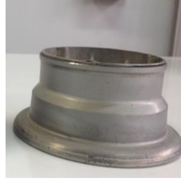
Şekil 14. Kontrol işlemi için uçaktan sökülmüş jant
