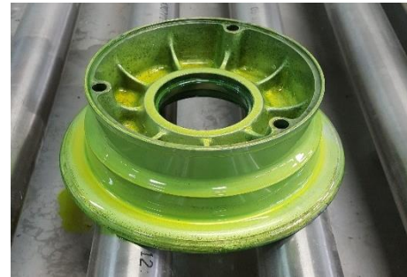
Şekil 15. Yüzeyine penetrant sıvı uygulanmış olan jant
