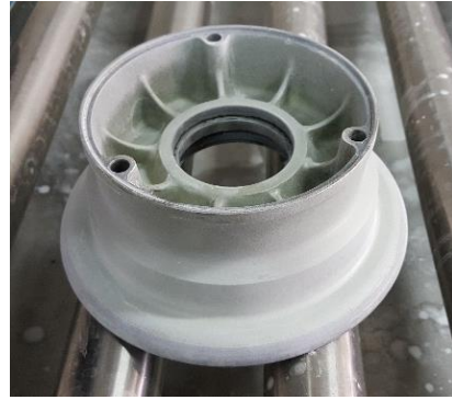
Şekil 17. Geliştirici malzeme uygulanmış olan jant
